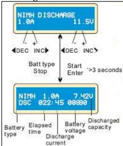
Le courant de charge est réglé sur la gauche et la tension finale à droite. La plage de courant de charge est de 0.1 à 1.0A ; la plage de tension finale est de 0.1 à 25.0V. Appuyer sur START/ENTER pendant plus de 3 secondes pour démarrer le programme.
