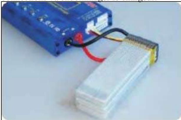
Avant de charger la batterie, les câbles principaux doivent être connectés au même titre que le connecteur d'équilibrage, comme indiqué sur le schéma.
