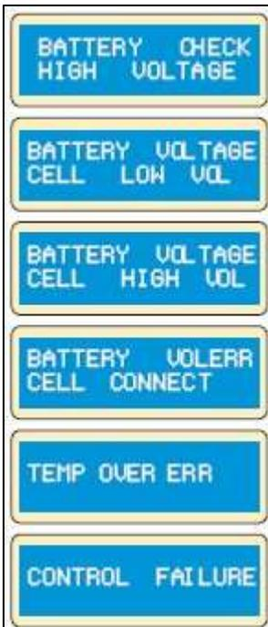
La tension est plus haute celle sélectionnée. Veuillez contrôler le nombre d'éléments de la batterie.
