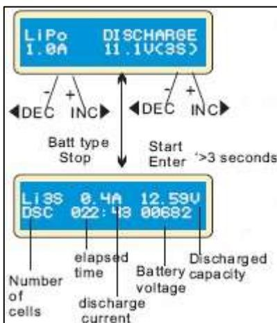
La valeur du courant de décharge à gauche ne doit pas excéder 1C, et la valeur à droite ne doit pas être inférieure à la tension recommandée par le constructeur pour éviter de trop la décharger profondément. Appuyer START/ENTER pendant plus de 3 secondes pour commencer à charger.
