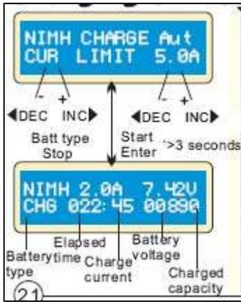
Ce programme sert pour la charge et la décharge des batteries NiCd/NiMH liées aux applications de modèles de R/C. Vous pouvez appuyer sur START/ENTER pour faire clignoter la valeur à ajuster puis sur INC ou DEC pour changer la valeur du paramètre. Appuyer sur la touche de START/ENTER pour enregistrer la valeur.
