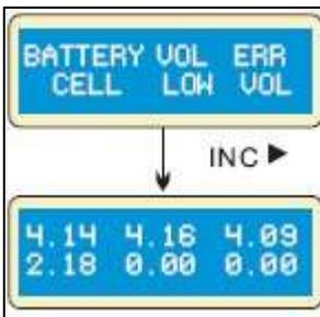
Le processeur détecte que la tension d'un élément est trop basse.
