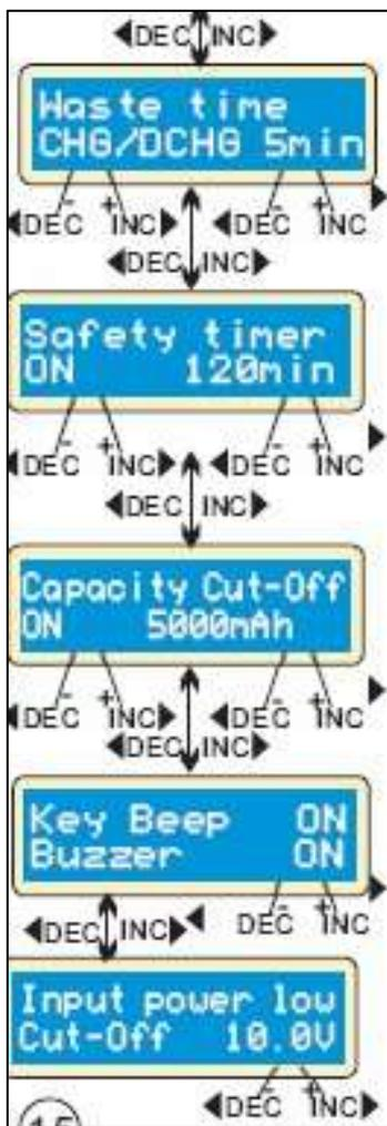
La batterie devient chaude après des cycles de charge/décharge. Le programme insérera un délai entre chaque processus de charge/décharge pour laisser à la batterie le temps de refroidir avant de début du nouveau cycle. La plage est réglable de 1 à 60 minutes.
