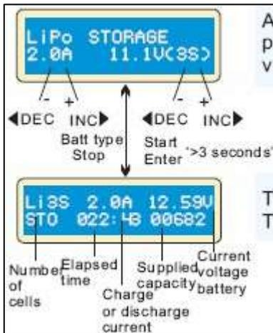
Sur cet écran, vous pouvez définir le courant et la tension de la batterie. La charge et la décharge ajusteront la tension de la batterie à celle définie dans les paramètres de stockage.
